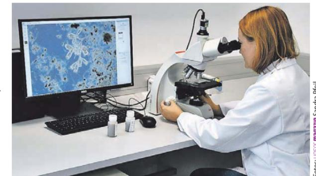
Mit modernster Technik wird der Belebtschlamm analysiert.
